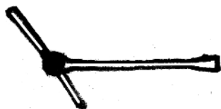
Klíč na šrouby se zářezem v hlavě – vývrtka
