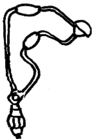
kolovrátek k vrtání do rohu
