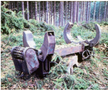
Obr. 3.61 Autonomní protahovací odvětvovací stroj APOS. (Archiv autora)
