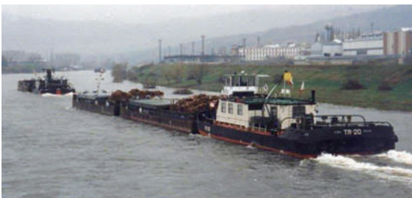
Obr. 3.224 Tlačná souprava naložená dřívím plující po Labi. (Archiv autora)
