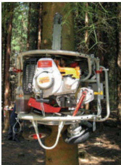
Obr. 2.75 Šplhací pily pro vyvětvování na stojato se u nás neprosadily. (Archiv autora)
