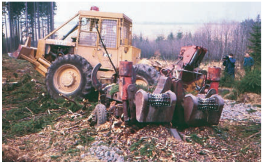
Obr. 3.62 Dvojitý APOS – Dablpos, APOS TWIN, umožňoval efektivní odvětvování i v porostech nižších hmotností, protože protahoval dva stromy současně. (Archiv autora)
