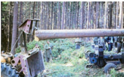
Obr. 3.63 Výsuvná lanová hubice na LKT při vkládání stromu do odvětvovače. (Archiv autora)
