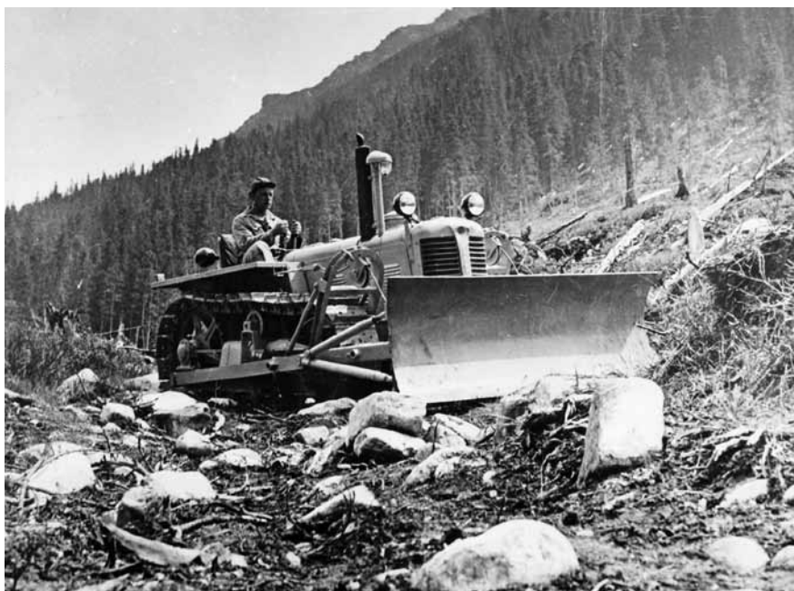
1. Traktor Zetor Super v pásovém provedení s buldozerovou radlicí. Rok výroby 1954.
