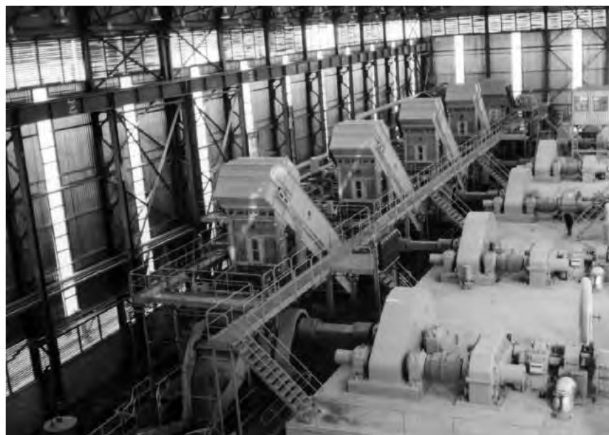
25/ Cukrovar SHOEBIEH v Íránu. Třtinová mlýnská stanice s pěti šestiválcovými mlýny, rozměry 42, 5 x 86 palců. Dobře viditelné jsou hrabčivé mezidopravníky s Donelli vspkami, snímek z roku 2000, archiv Jaroslava Bartoška
